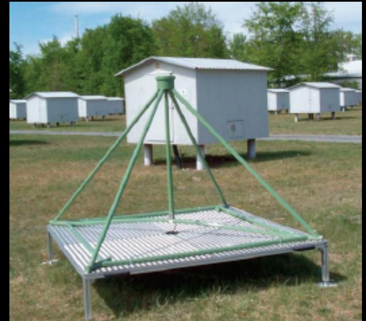
**ANTENNA TRIGGERED BY PARTICLE DETECTORS**
